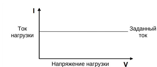
Рисунок 4.3.1-1. Режим CC: зависимость напряжения от тока
