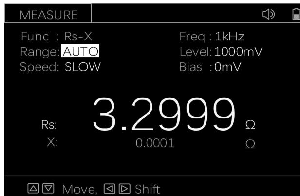
Fig 21 System default measuring parameter
